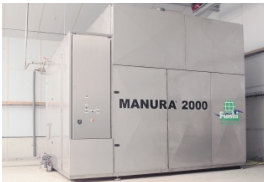
Funki MANURA Compact, hører til den højteknologiske gruppe. Gyllen opdeles i koncentrerede næringsstoffer og "rent" vand.
