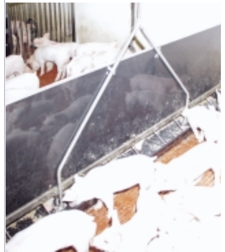
Baby Feeder kan udfodre frisk vådfoder mange gange i døgnet, fx i en langkrybbe.
