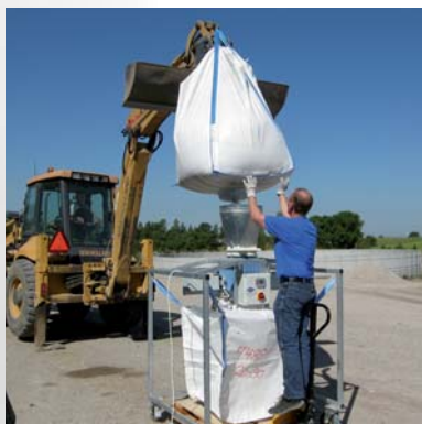
Big-baggen tømmes ned gennem prøveudtageren og ned i en ren big-bag.
