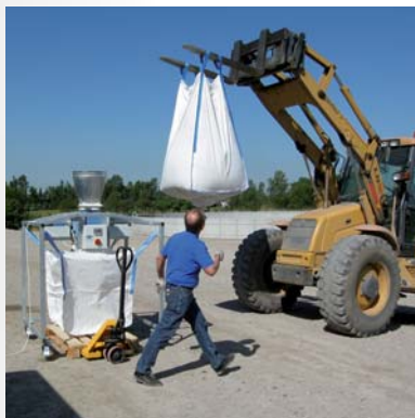
En big-bag med mineralsk foder hæves op over prøveudtageren.
