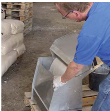
Spandens indhold neddeles vha. en spalteprøveneddeler.
