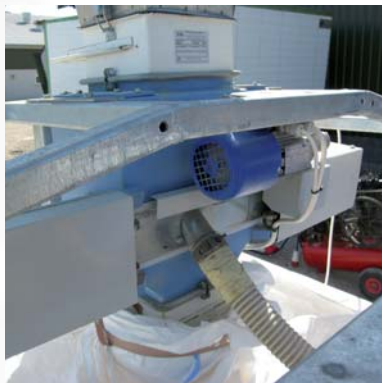
Der udtages ca. 50 "tværsnit" af indholdet i big-baggen.
