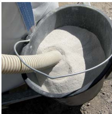
De mange delprøver, som nu er en repræsentativ prøve af hele sækens indhold, samles i en spand.
